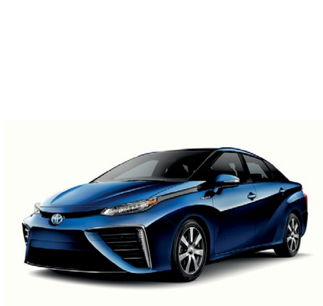
Toyota Mirai – världens första serietillverkade bränslecellsbil som lanserades under 2015 i Japan och Kalifornien.
