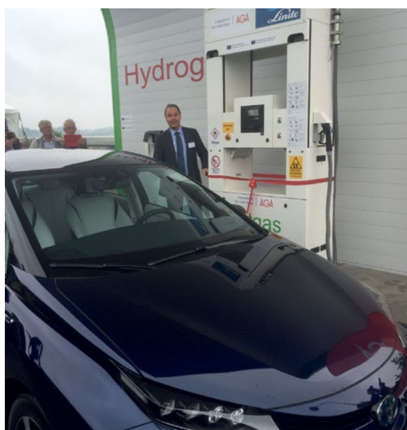
Vätgastankning av bränslecellsbil. En tankning tar 2–3 minuter.
