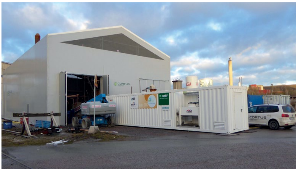
SNG-process i containern som är uppställd utanför WoodRoll® demonstrationsanläggning i Köping. Processen uppgraderar gasen från WoodRoll® till SNG (förnybar naturgas).
